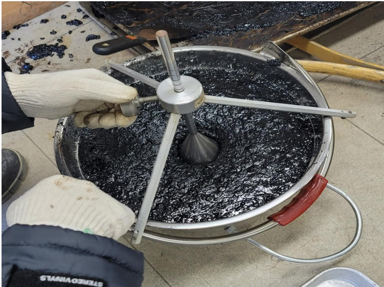
그림 3. 류엘 유동성 시험
