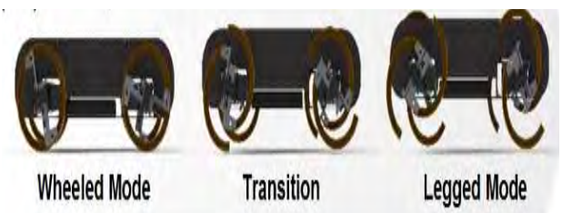
(그림 2) Turboquad 휠 변형 과정
