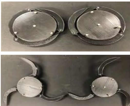
(그림 3) 일반적 Wheel(위)과 변형한 형태인 Legged-wheel(아래)
