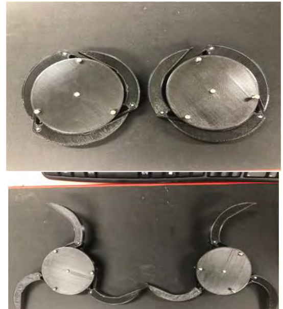
( 그림 4. Wheel 3D Printer 출력 )
