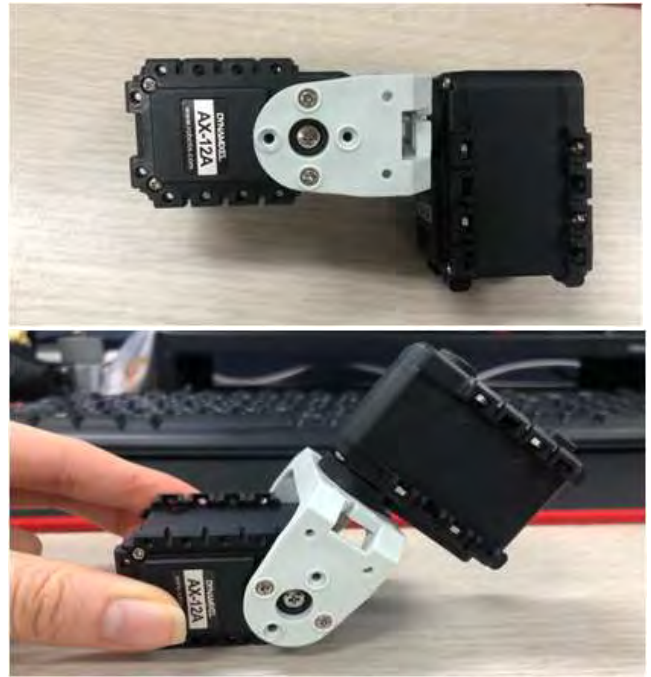
( 그림 8. 로봇 관절을 위한 Dynamicxel 조립 )
