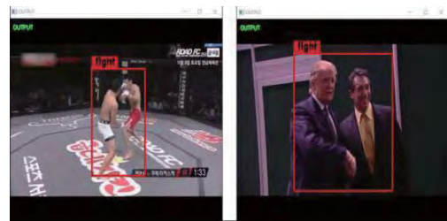
[그림 2] Object Detection 기반 폭력 탐지 결과
