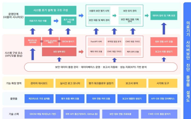
<그림 2> 의료기기 보안성 검증 시뮬레이터 시스템 아키텍처 설계도
