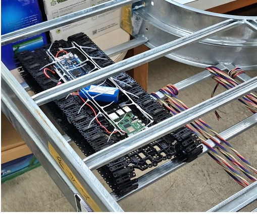
(그림 2) AI 기반 덕트 자율주행 로봇
