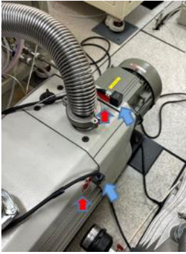
그림 1. 진동 센서 및 온도센서의 부착
