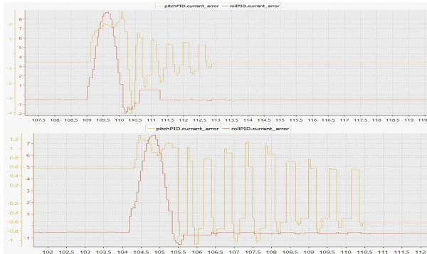
(그림 4) (상) PID 제어 (하) 퍼지 PID 제어 초기 PID 그래프
