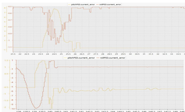
(그림 5) (상) PID 제어 (하) 퍼지 PID 제어 시간 경과 후 PID 그래프
