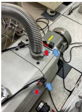
그림 1. 진동 센서 및 온도센서의 부착
