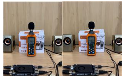
그림 4 - (좌)역위상을 출력하기 전 소음의 크기, (우)예측한 소음의 역위상을 출력했을 때 소음의 크기
