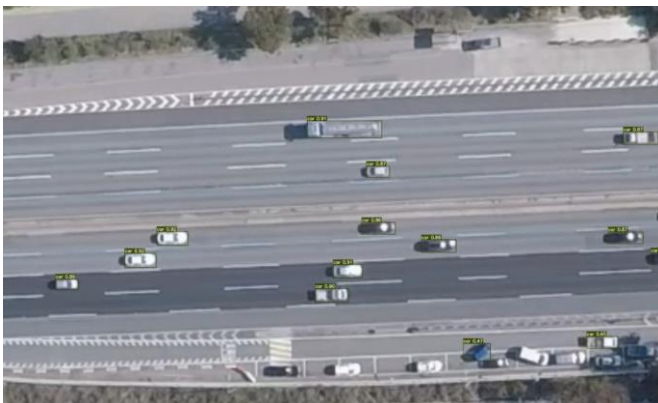
(그림 2) 직접 학습한 YOLOv7 모델을 가지고 차량 탐지(detection)한 모습. 탐지된 Namsa 비디오 중 한 장면을 캡처.
