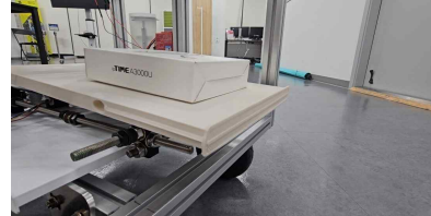
그림 4. RFID리더기 태그 후 스텝 모터를 이용하여 택배 하차
