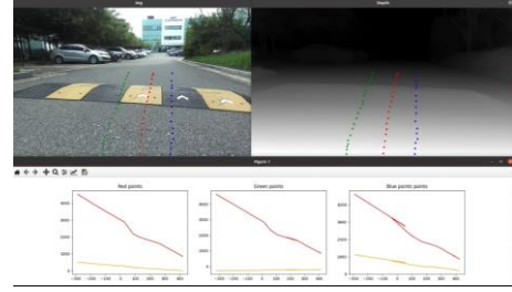
(그림 5) 방지턱에서의 그래프(방지턱에 해당하는 영역에서 기울기가 일정하지 않게 감소)
