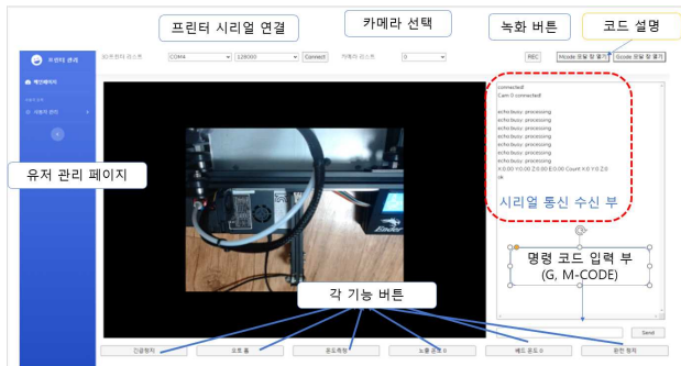
사진3-1 원격제어 시스템 메인화면 및 기능 설명
