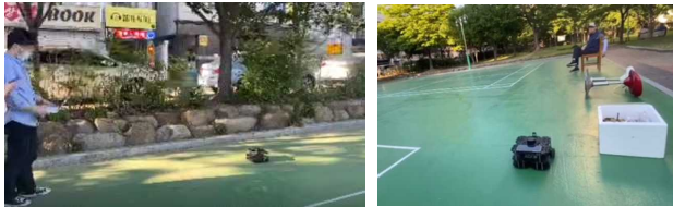
(그림 7) 사용자와 거리를 유지한 채 주행하는 로봇(왼쪽)과 지정한 경로를 일정속도로 주행하는 로봇(오른쪽)
