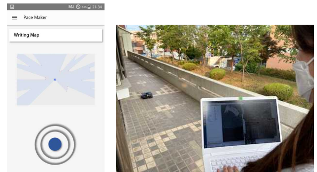
(그림 5) '지도작성-로봇조작' 기능 화면(왼쪽)과 로봇의 동작 모습(오른쪽)
