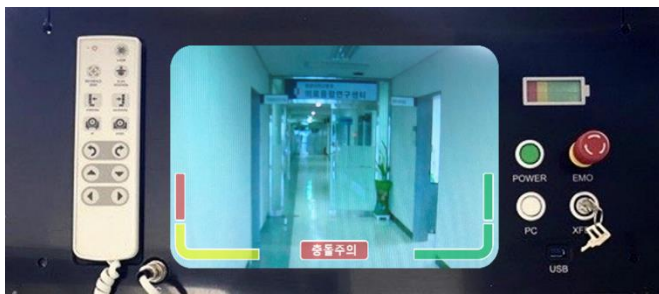
(그림 8) 통합 임베디드 컨트롤러 실제 구현 사진
