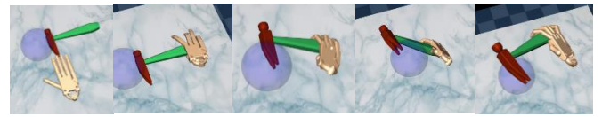
(그림 5) DAPG를 통해 학습한 로봇손이 시간에 따라 망치를 파지하는 과정
