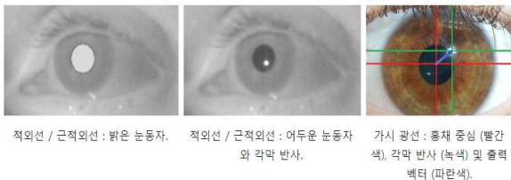
(그림 5) 동공 검출 및 시선 벡터 사진
