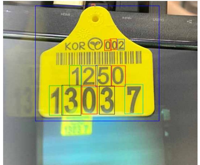
그림 1. 한우 귀표 일반형에 대한 영역 검출 및 개체번호 인식 동작 예하였다. 앱은 카메라 API를 통해 영상을 입력받아 경량화된 귀표영역 검출 모델 및 개체번호 인식 모델에 이미지 프레임을 전달하여 사용자의 시야 안에 있는 축산동물 귀표의 개체식별 번호를 인식한다. 인식된 개체식별번호는 별도의 축산 개체관리 플랫폼과 연계하여 현장의 가축정보를 갱신하는데 활용한다.
