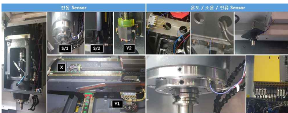
그림 2. 핵심 부품 상태 진단을 위한 센서 부착 예시
