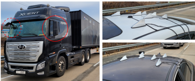
그림 1. 시험에서 사용된 안테나 및 차량 별 배치 (좌: 대형차 1, 2 측면거울 내장, 우상: 소형차 1, 우하: 소형차 2)
