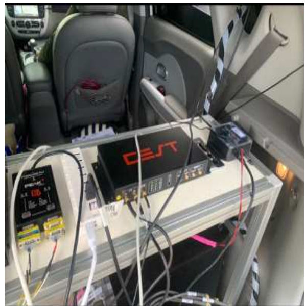
그림 1 실제 차량에 설치된 WAVE 모듈(WAVE)
