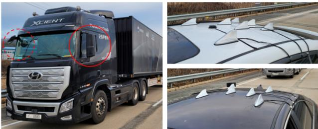
그림 1. 시험에서 사용된 안테나 및 차량 별 배치
